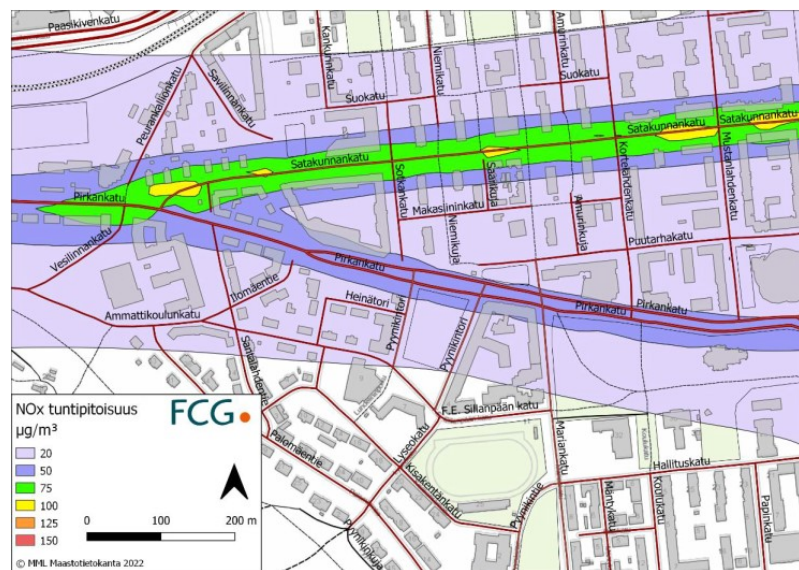
Kuva 23: Typpioksidin arvioitu suurin mahdollinen liikenteen aiheuttama tuntipitoisuus vuoden 2021 liikennemäärillä. Arvioitu taustapitoisuus 10 \mu\text{g}/\text{m}^3 ei ole mukana. Kuva: Ilmanlaatuselvitys, FCG Finnish Consulting Group Oy 2022.
