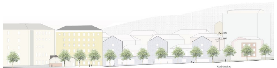
Kuva 34: Vaihtoehdossa 2 Heinäpuistoon osoitettiin rakennusmassa, joka koostuu kolmesta 4-kerroksisesta lamellista ja 1-kerroksisesta osasta Pirkankadun varrella. Rakennus sopeutui Pyynikintorin kaupunginosan rakennuskannan mittakaavaan. Rakennuksessa oli harjakatto ja Pirkankadun varren matalamassa osassa viherkatto, joka soveltuu myös asukkaiden oleskeluun. Heinäpuiston täydennysrakentaminen, VE2, katujulkisivu Pirkankadulta etelään, viitesuunnitelma, kuva AOR Arkkitehdit.
