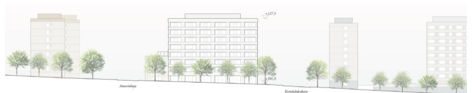
Kuva 28: Vaihtoehdossa 1 Puutarhakadun tontille osoitettu uudisrakennus toisti Korttelahdenkadun ympäristössä olevien 1960–70-luvuilla rakentuneiden lamellitalojen korkeutta, massoittelevaa ja kattomuotoa. Tontin länsi- ja pohjoisreunalla oli pienialainen asukas- ja oleskelupiha ja lisäksi piha-alueita oli osoitettu rakennuksen katolta. Puutarhakadun täydennysrakentaminen, VE1, katujulkisivu Puutarhakadulta pohjoiseen, viitesuunnitelma, AOR Arkkitehdit.
